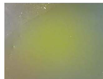
Поле зрения микроскопа до и в момент начала кристаллизации парафинов в конденсате
